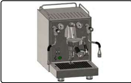
Abb. 9 Filterträger installiert, Griff nach vorn gerichtet
