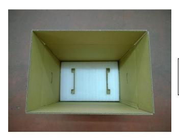
Legen Sie die untere Schaumstoffeinlage auf den Boden der Kartonage. Die Maschinenfüße werden später in die vier Aussparungen gestellt.
