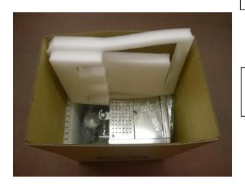
Setzen Sie die obere Schaumstoffeinlage, wie auf dem Foto zu sehen, ein. Die Maschine kann nun in der seitlichen Position nicht mehr verrutschen.
