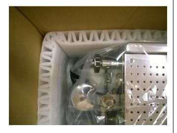
Setzen Sie die äußere Schaumstoffeinlage um die Maschine ein.
